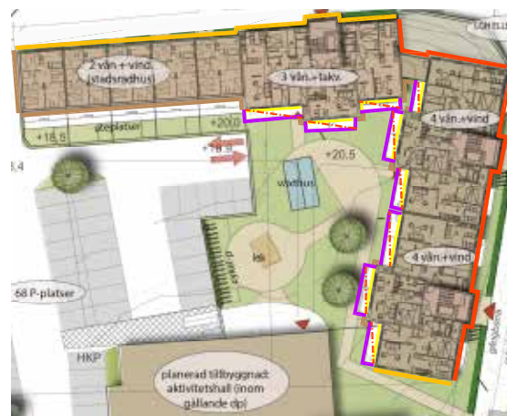
Utdrag ur bullerutredning som visar beräknad ekv. ljudnivå.
